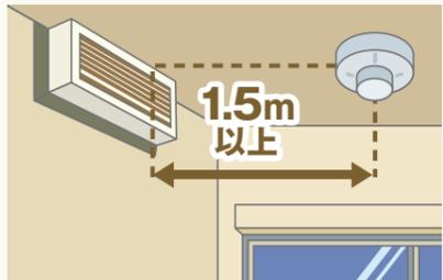
火災警報器とエアコンの吹き出し口は**1.5m以上**離して設置してください。
